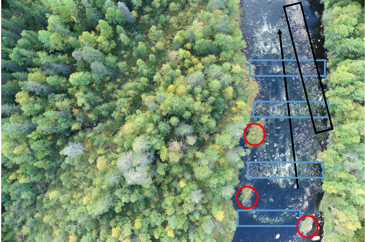
Figur 47. Drönarflygning den 12/9 2022. Röd ring = strandvegetation som tillskapats. Svart polygon = kulturobjekt stenmur som rivits ut. Blå polygon = tröskel som rivits ut. Heldragen svart pil markerar huvudfåra.
