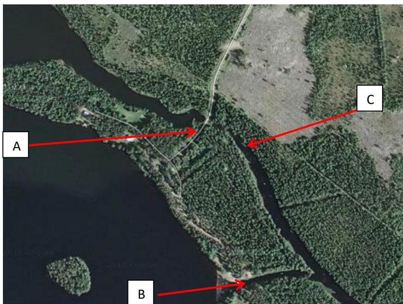
Figur 30. Karta över Ramsans inlopp i Sundö. A. Gamla fåran. B. Grävd kanal. C. Vägtrumma, ny bro.
